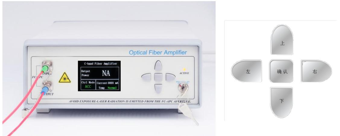
2. 液晶屏实时显示以下信息：工作模式、泵浦激光器电流。放大器激活指示灯 ACTIVE 用于指示放大器输出状态，仅当该指示灯亮起时放大器为激活状态，有激光输出。脉冲型 EDFA 光纤放大器标准型号工作模式：自动电流控制模式(ACC mode)，
